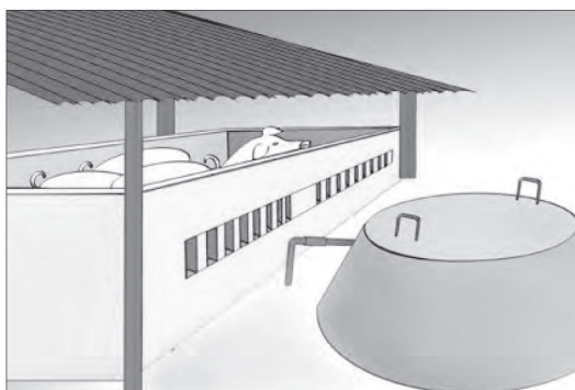
図72b. バイオガス施設を慎重に設置する。バイオガスの収集と利用のための場所と経路を設計する。地元の良い例から学ぶ。
