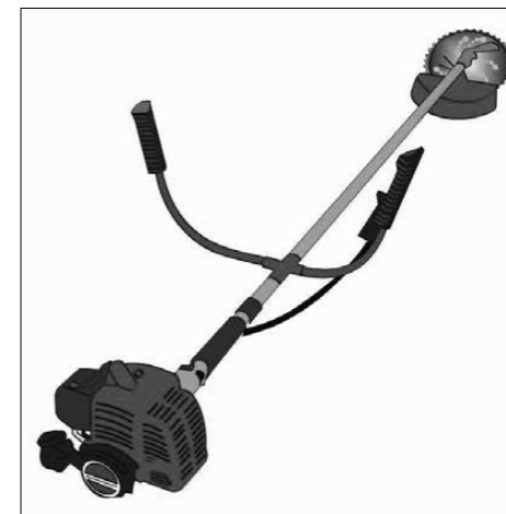
図30b. 手持ち式の動力器具のためには、予期せぬ動きから手や足を保護するための特別なガードが必要です。
